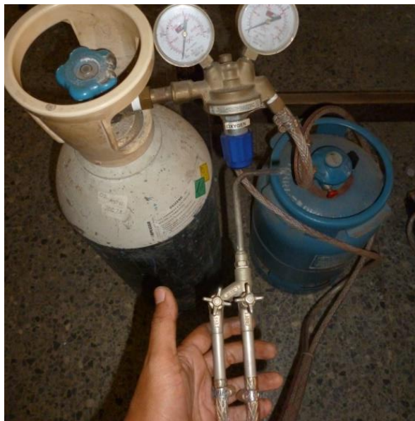
Gambar 11. peralatan untuk teknik las oksidasi-asetilin (Foto: Izza, 24 mei 2018)
