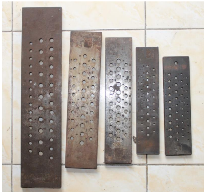
Gambar 10. Draw plate atau alat untuk mengecilkan ukuran kawat dan mengubah plat menjadi pipa (Foto: Izza, 24 mei 2018)
