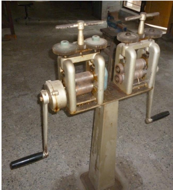
Gambar 9. Rolling Mill alat untuk menggilas dan memipihkan logam (Foto: Izza, 24 mei 2018)
