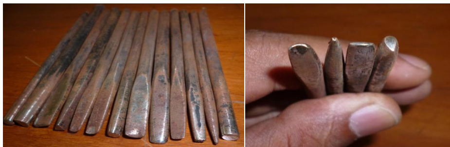
Gambar 8. Jenis pahat untuk keteknikan ukir logam (Foto: Izza, 24 mei 2018)
